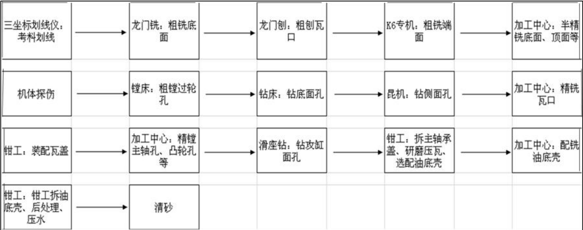
图4.2-5 机体加工生产工艺流程图
